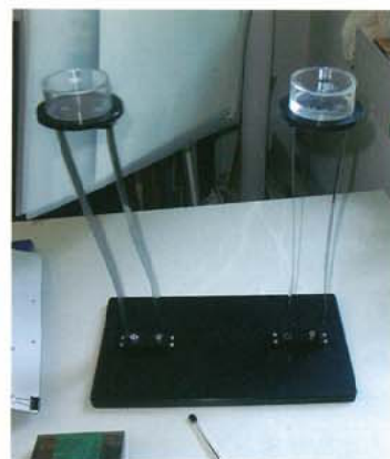
写真3 水を使ったダンパーのモデル。同じように揺らすと、水を入れた右の容器の方が早く揺れが治まる
